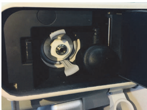
Figura 3-12 Inserire il supporto del sensore O 2 nel sistema respiratorio
