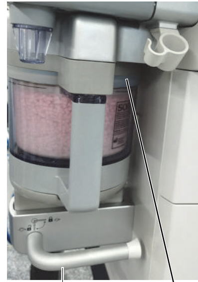
Posizione di bloccaggio. Il bypass è disattivato.
