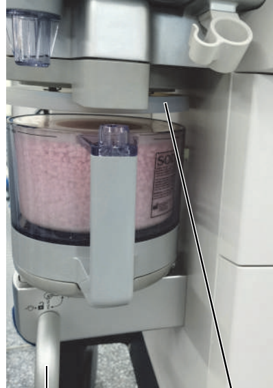
Posizione di sblocco. Il bypass è attivato.
