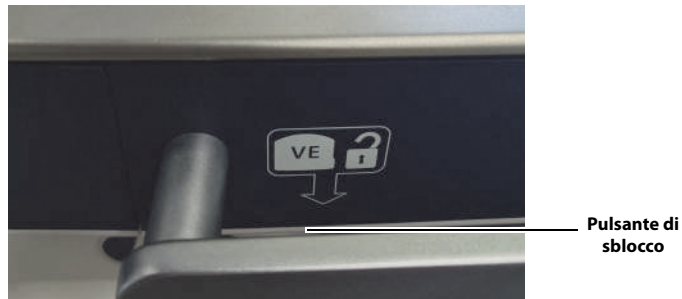
Figura 3-1 Aprire il coperchio dello scambiatore di volume
